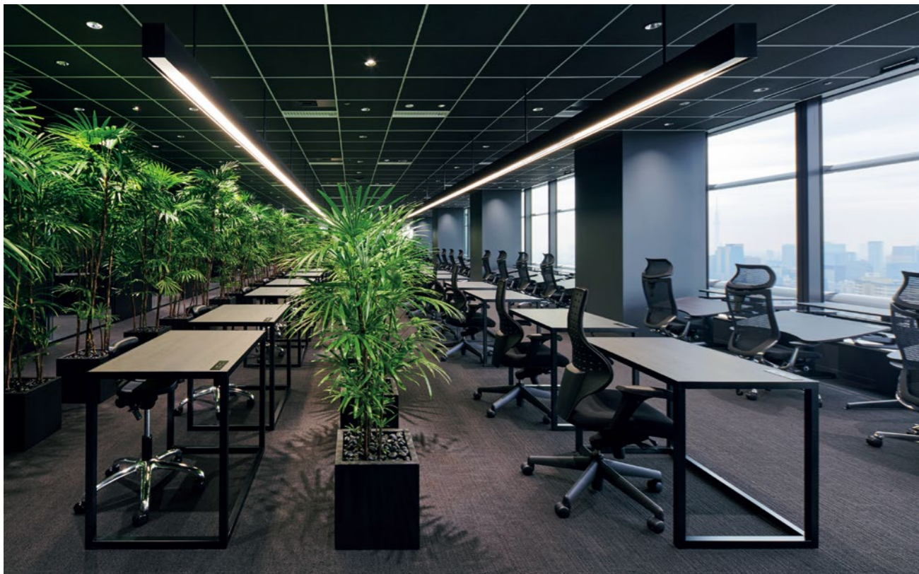
オープンワークスペース。列ごとに前傾姿勢、標準姿勢、後傾姿勢を促すテーブルとイスが並び、思考や作業に合わせて選択できる。視野角に10%以上の緑が入るように植栽計画がされている。太陽光に合わせて照明の明るさや色温度も変わっていく
